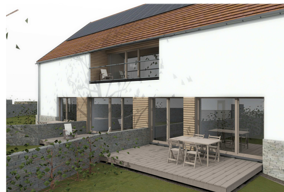
POHLED NA TERASU PŘÍZEMNÍHO BYTU kamenné obložení soklu domu pohledově navazuje na dělicí kamenné zidky
